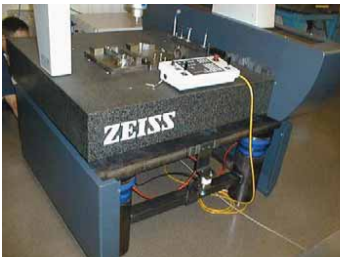
PAL减振器装在ZEISS坐标测量机的支撑框架
