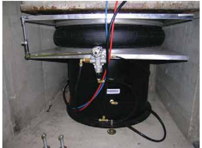
配有阻尼腔的单曲气囊型减振器和水平调节阀用在电磁振动台的质量块下。
