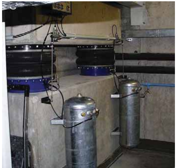
双曲气囊型减振器配有辅助气罐、阻尼腔和水平调节阀。用在测功机台架的质量块下。
