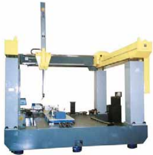
减振系统在多轴高精密-光学微结构钻石切削加工系统中应用
