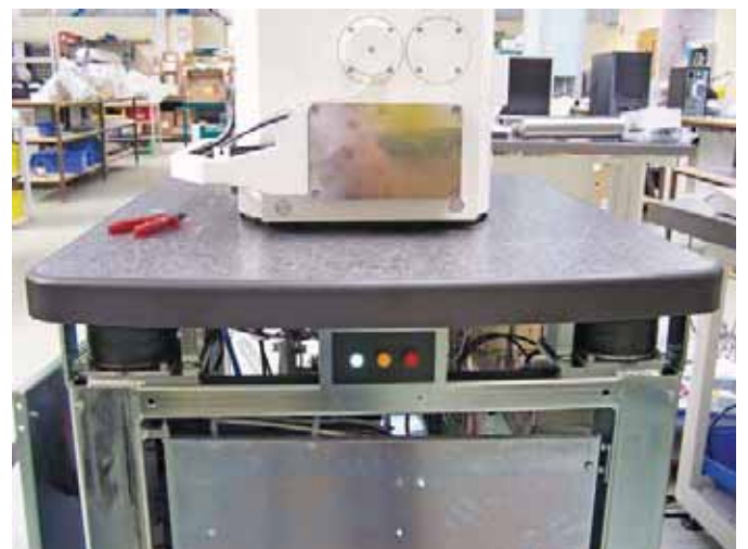
PLM-3减振器安装在Zeiss EVO系列扫描电子显微镜的支架中，使得放大超过30万倍的X射线几何和电子成像可以清晰的呈现。
