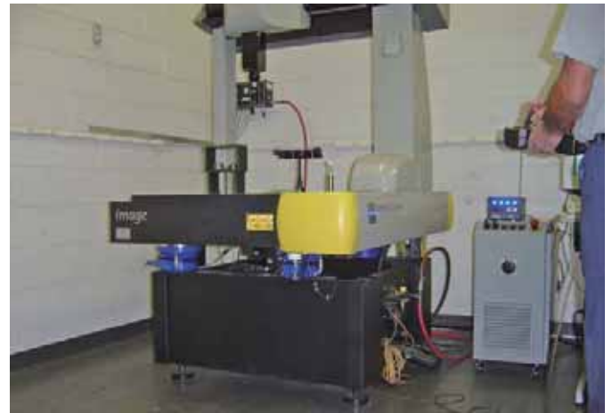
\Delta K 气浮式减振系统应用在Brown & Sharpe Global 7.10.7 CMM中，允许其在设计速度和精度内进行测量。
